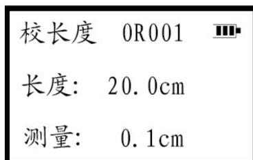
注意事项：仪器出厂时已经校正，正常使用时不需要此项校正。在没有标准长度时，不要进行校正，以免出现校正后测量数据不准确。（在仪器出厂时我们配备了标准卡片 200\*50mm，可用于检测面积测量是否准确。若误差较大，请重新校正长度即可。）
